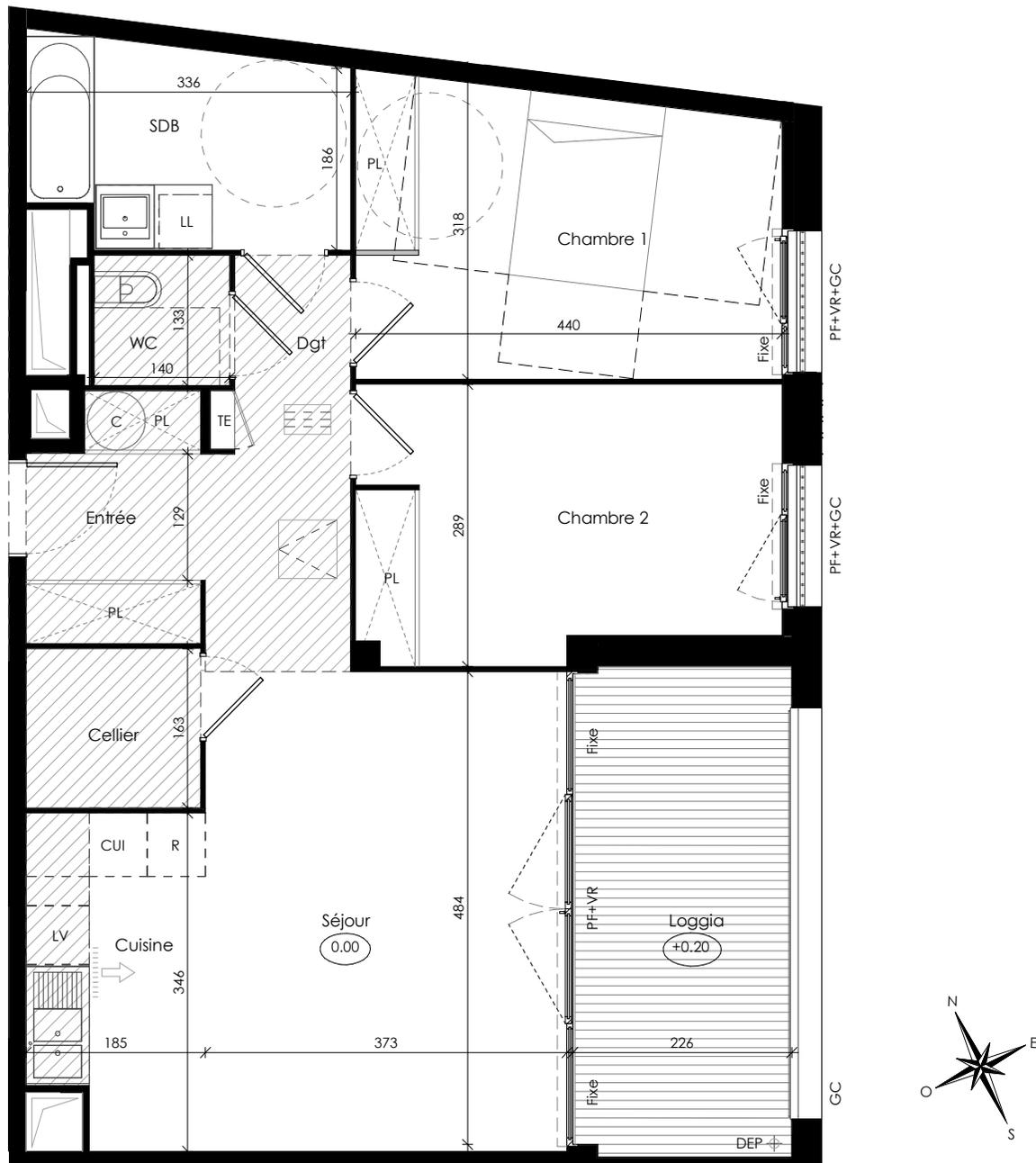
LEGENDE: PF: Porte-Fenêtre / F: Fenêtre / VR: Volet roulant / ST: Store extérieur / GC: Garde-corps / TE: Tableau électrique / PL: Placard / CUI: Cuisson / R: Réfrigérateur / LL: Lave-linge / LV: Lave-vaisselle
