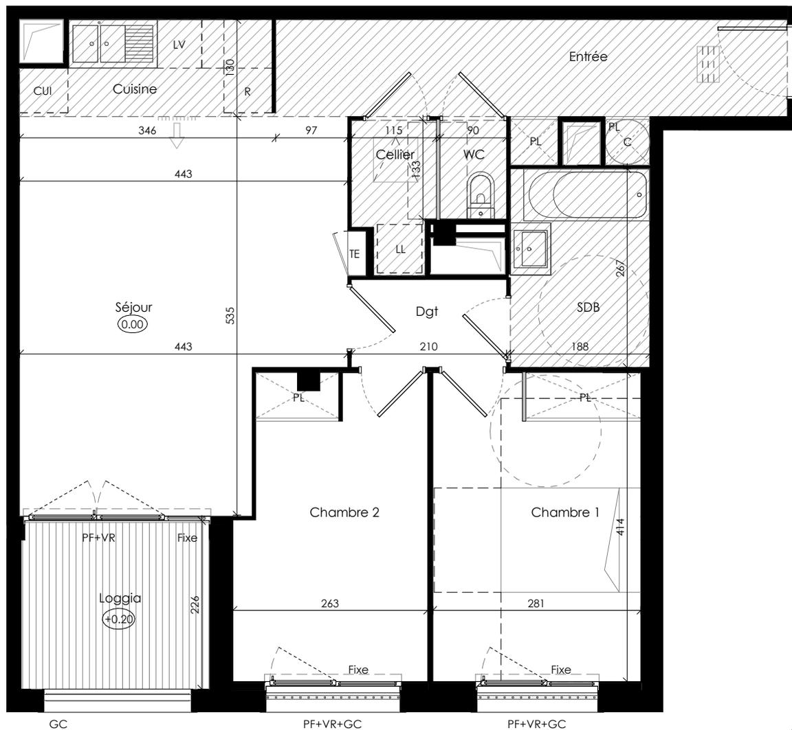
LEGENDE: PF: Porte-Fenêtre / F: Fenêtre / VR: Volet roulant / ST: Store extérieur / GC: Garde-corps / TE: Tableau électrique / PL: Placard / CUI: Cuisson / R: Réfrigérateur / LL: Lave-linge / LV: Lave-vaisselle
