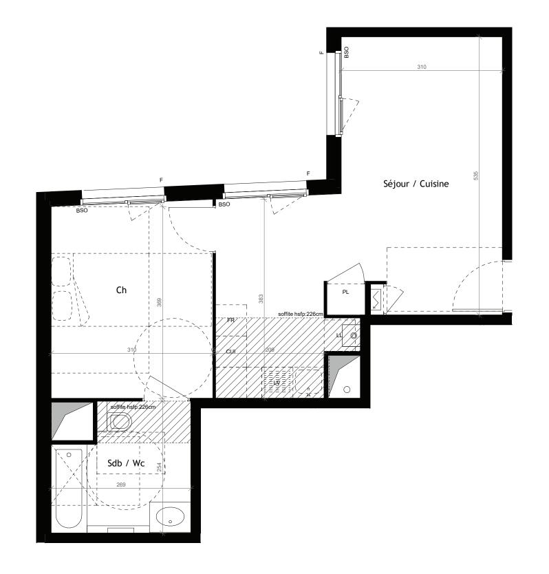
LEGENDE: PF: Porte Fenêtre / F: Fenêtre / BSO: Brise-Soleil Orientable / VR: Volet Roulant / TE: Tableau Electrique / PL: Placard / CUI: Cuisson / FR: Réfrigerateur / LL: Lave Linge / LV: Lave Vaisselle / Soffite, faux plafond :
