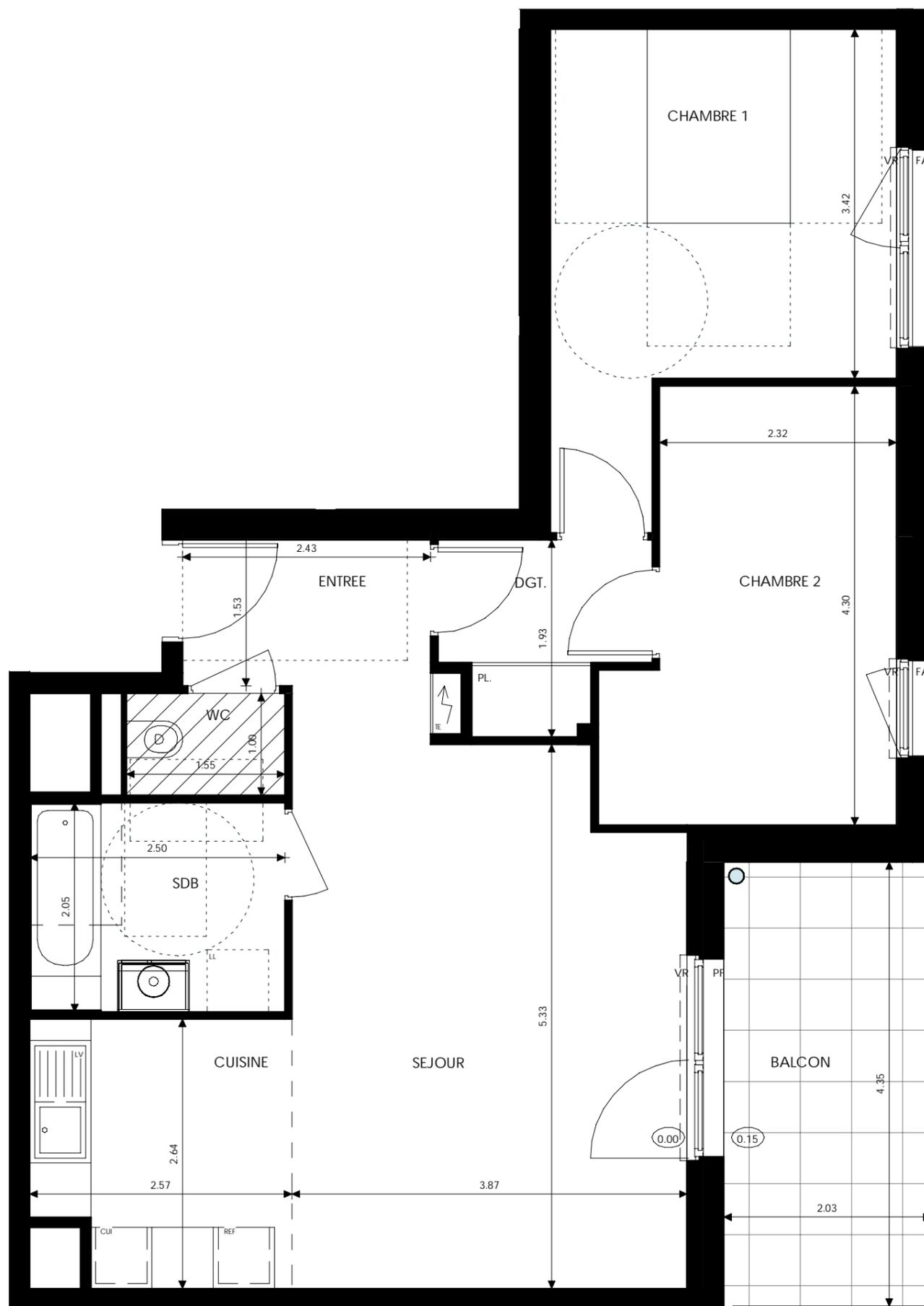
LEGENDE: PF: Porte-Fenêtre / F: Fenêtre / FAB: Fenêtre Allège Basse / VR: Volet Roulant / TE: Tableau Electrique / PL: Placard / CUI: Cuisson / R: Réfrigérateur / LL: Lave Linge / LV: Lave Vaisselle / Soffite, faux plafond : / Niveau
