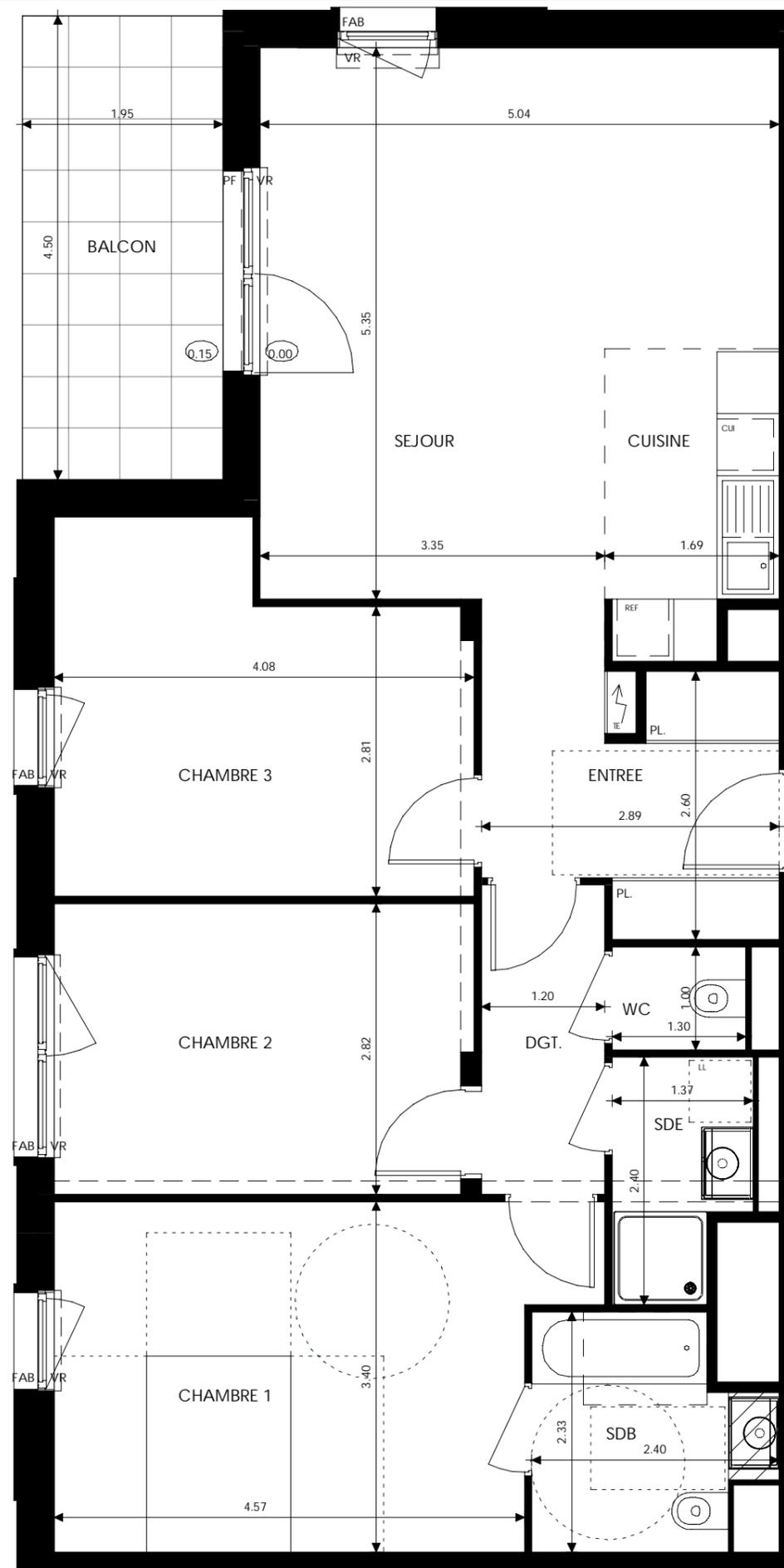
LEGENDE: PF: Porte-Fenêtre / F: Fenêtre / FAB: Fenêtre Allège Basse / VR: Volet Roulant / TE: Tableau Electrique / PL: Placard / CUI: Cuisson / R: Réfrigérateur / LL: Lave Linge / LV: Lave Vaisselle / Soffite, faux plafond : / Niveau
