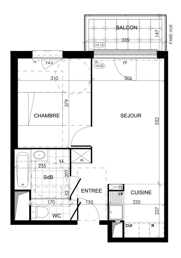
LEGENDE: PF: Porte Fenêtre / F: Fenêtre / FAV: Fenêtre Allège Vitrée / VR: Volet Roulant / TE: Tableau Electrique / PL: Placard / CUI: Cuisson / R: Réfrigerateur / LL: Lave Linge / LV: Lave Vaisselle / Soffite, faux plafond :
